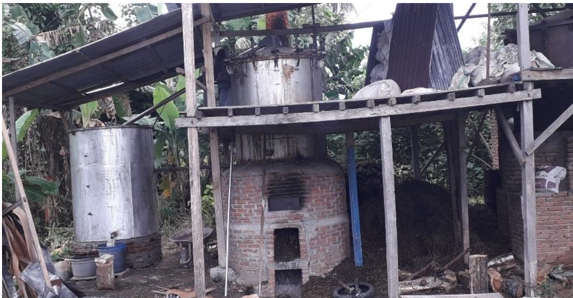
Gambar 1. Konsep Alat Penyulingan Minyak Atsiri sederhana skala rumahan
