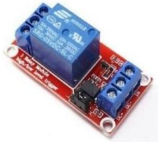
Gambar 2. 3 Bentuk Fisik Relay (Fitri dkk, 2019).
